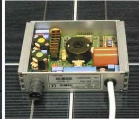
**Der Mann, mit dem alles begann: Bereits vor 15 Jahren entwickelte der Niederländer Henk Oldenkamp einen Miniwechselrichter, der 130 Watt Gleichstrom in Wechselstrom umwandeln konnte und direkt auf der Rückseite eines Solarmoduls befestigt wurde – der OK4, eines der ersten Geräte seiner Art.**
